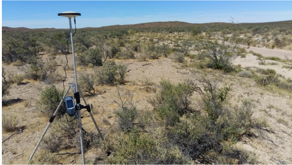
Figura A4.4. Relevamiento con GPS Magellan Promark 3 del Arroyo Armanino en un tramo que incluye a la estación de aforo.
