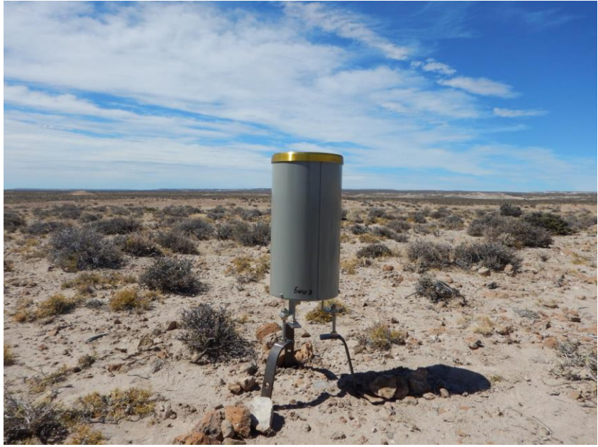
Figura A3.2. Pluviómetro instalado con estación meteorológica y uno de los cuatro pluviómetros instalados en la Cuenca Armanino (ver Figura 5).
