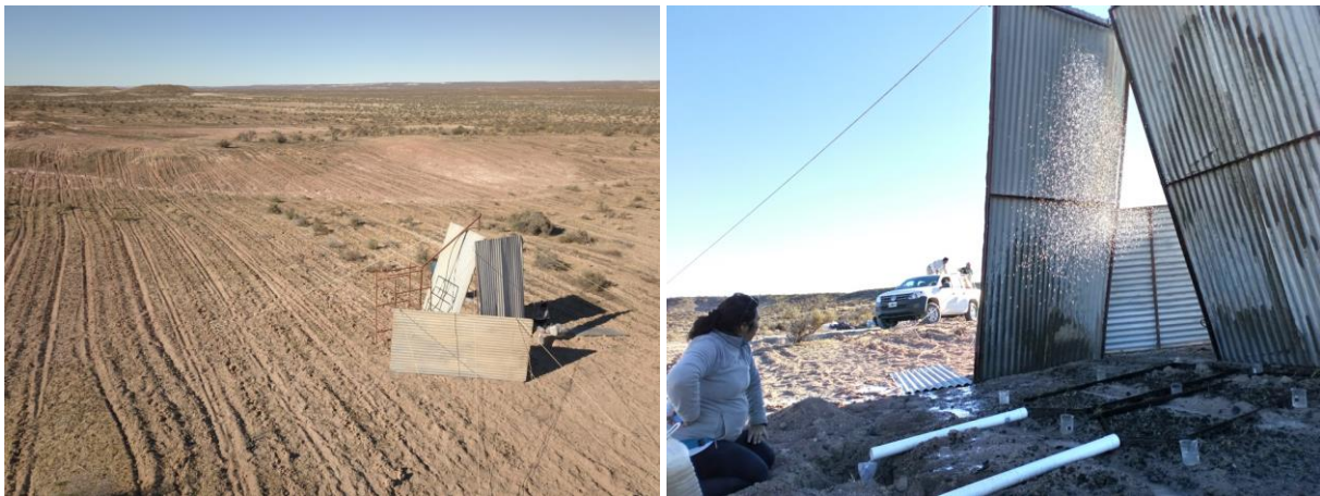
Figura A6.1. Dos vistas de los experimentos con el simulador de lluvia instalado sobre la zona laboreada. Se utilizan paneles de chapa para proteger al experimento del fuerte viento de la zona y lograr un patrón homogéneo de precipitación sobre las parcelas experimentales. A la derecha se pueden ver las dos parcelas durante el experimento y los tubos colectores de agua y sedimento escurrido.
