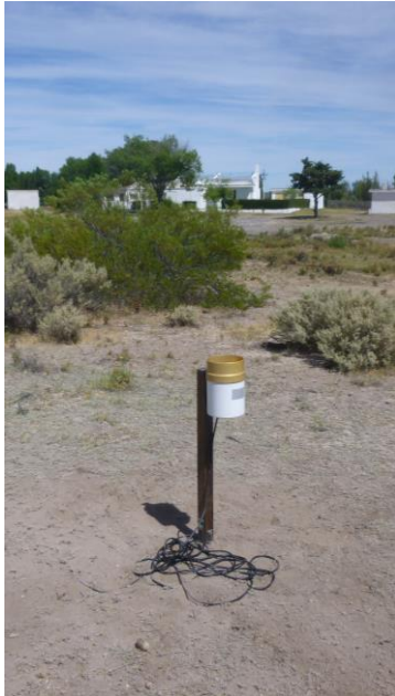
Figura A3.2. Pluviómetro instalado con estación meteorológica y uno de los cuatro pluviómetros instalados en la Cuenca Armanino (ver Figura 5).
