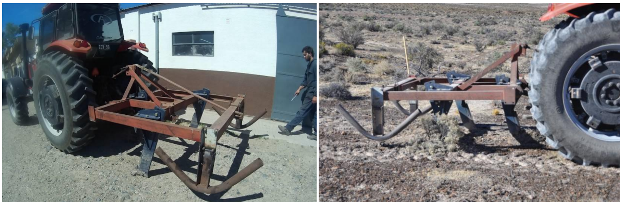
Figura A5.1. Equipo utilizado en la tarea de subsolado durante el armado en la EEA Chubut del INTA y en operación en la Cuenca Armanino.
