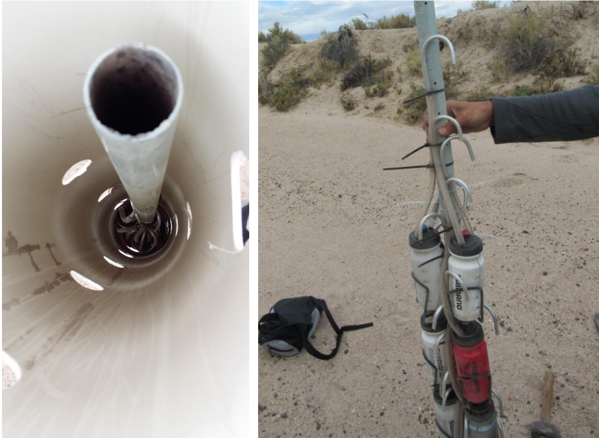
Figura A4.2. Izquierda: Vista del interior de la estación de aforo. Se observan los orificios en las paredes del tubo de PVC, el mástil en el centro del tubo que contiene las botellas colectoras de sedimentos. Derecha: detalle del mástil con las botellas recolectoras de muestras de sedimentos. se parecía el sistema de tubos para el control de las profundidades de muestreo.
