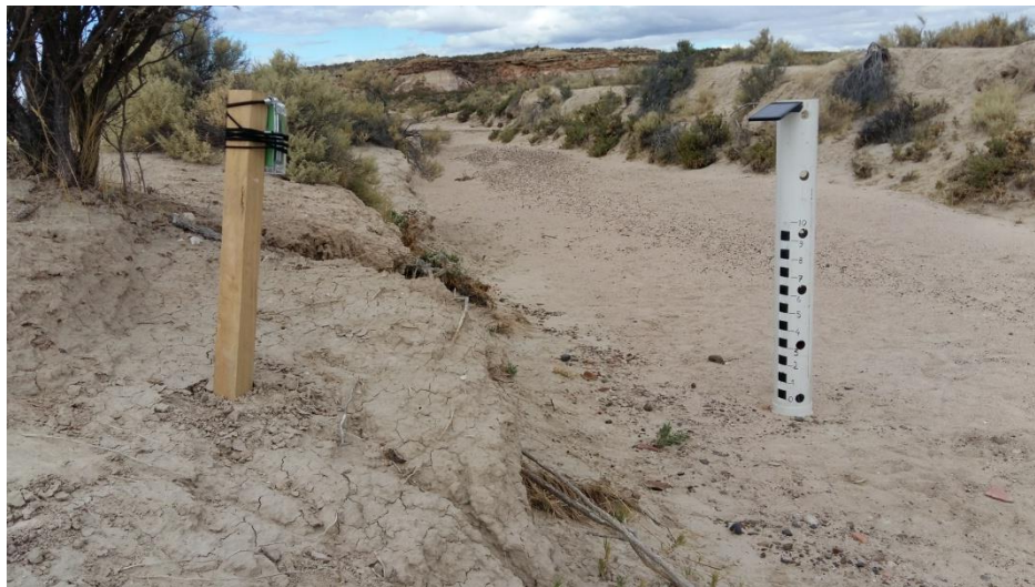
Figura A4.1. Vista de la estación de aforo en el Arroyo Charito. Se observa el tubo de PVC con la escala graduada y en el extremo superior, la lámpara con panel solar. En primer plano se encuentra la cámara fotográfica.
