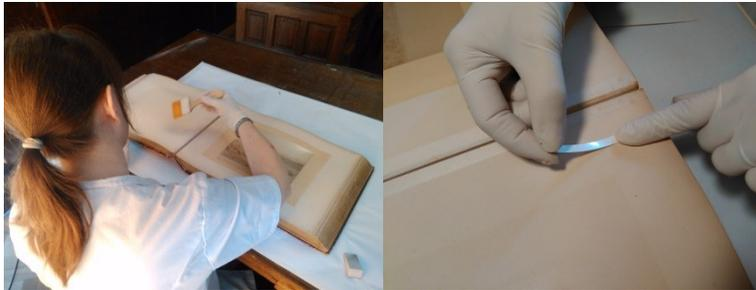
Limpieza mecánica en seco con pinceleta. Medición de pH
