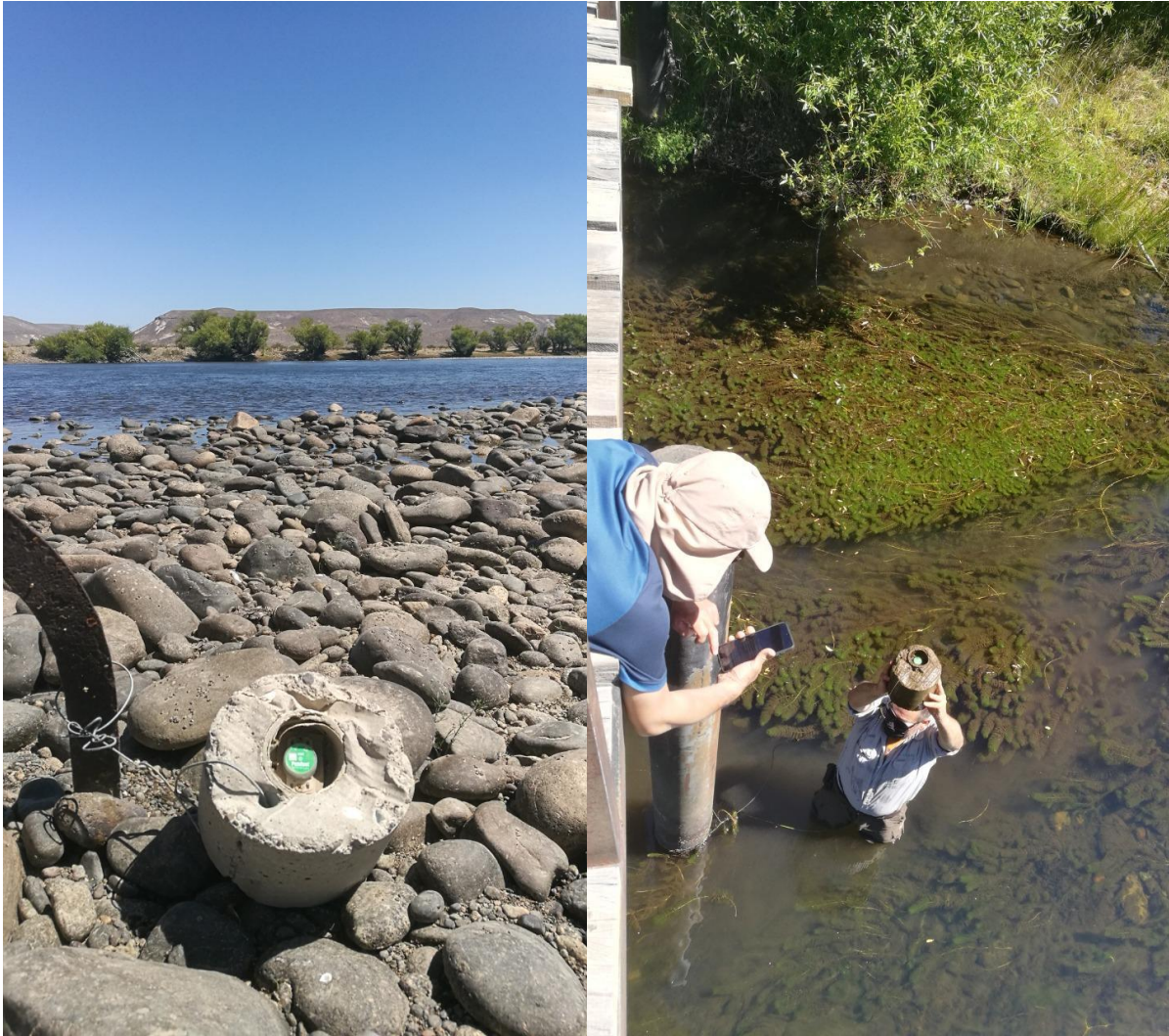
Figura A6.1: Izquierda: Detalle de los data loggers (azul temperatura; verde temperatura y luz) e instrumento fuera del agua para mostrar anclaje en bloque de hormigón y alambre de seguridad sujeto a punto fijo. Derecha: lectura de los registros desde un data logger en el campo mediante un celular y vía Bluetooth. El instrumento debe estar fuera del agua para que la lectura via bluetooth sea posible.
