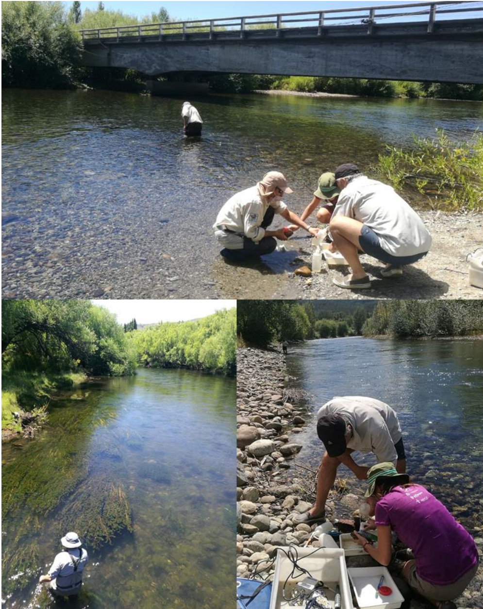
Figura A3.1: Actividades de muestreo en río. Mientras dos o tres personas registran datos con instrumentos digitales y toman las muestras de agua y de biofilm sobre rocas, otras dos o tres registran cobertura de algas, datos de los data loggers o realizan muestreo de macroinvertebrados.
